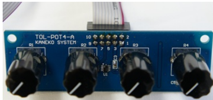
図 2 リボンケーブル接続例
